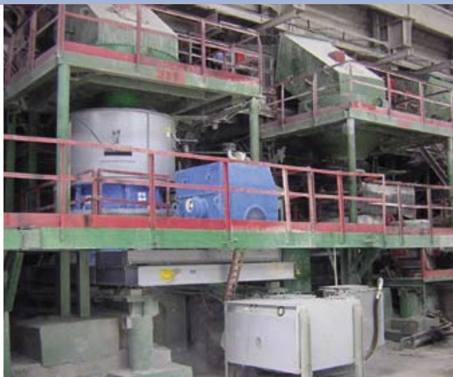
Рис. 1. Дробилка Sandvik H 6800 на 3-й стадии дробления ОАО «Павловскгранит».
