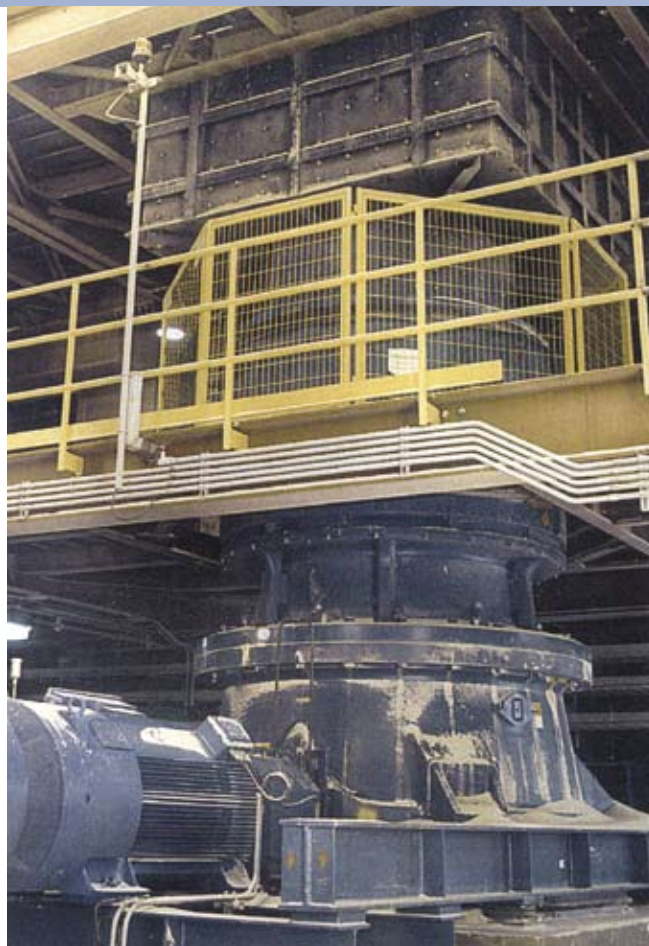
Рис. 2. Дробилка Sandvik H 8800 на горном предприятии в Чили.
